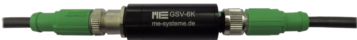
GSV-6K: 12V/24V Versorgung, Ausgang: Strom / Spannung, 1x Sensor mit DMS Vollbrücke
