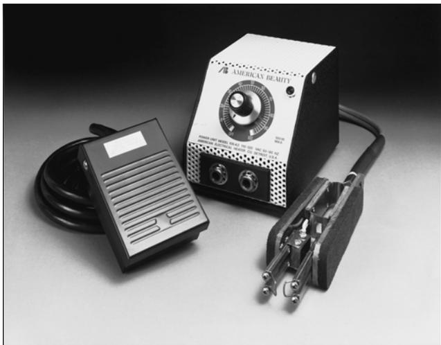
Die einfache Handhabung der thermischen Abisolierzange macht sie zum idealen Werkzeug für die meisten Abisolieraufgaben. Die variable Temperatursteuerung erlaubt das Abisolieren aller Thermoplaste, einschliesslich Teflon®, mit Durchmessern von 0.1mm bis 1mm. Fusschalter und Elektrodenhandgriff gestatten ausgezeichnete Arbeitskontrolle. Das Gerät besteht aus Steuertransformator und Fusschalter (beide mit 3-leiter NEMA-Stecker und Elektrodenhandgriff).
