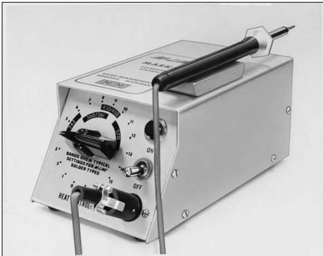
Lang erprobte Präzisions-Lötstation, besonders geeignet für kleinste Lötstellen und sonstige delikate Lötarbeiten. 25W Leistung in 17 einstellbaren Temperaturstufen für alle Lötzinlegierungen, ausser 1240 FPA. Magnet-LötKolbenhalter und flexibles, temp.-resistentes Kabel. Leichter LötKolben (31g). Für Anschlusswerte 115VAC oder 220VAC, 60 oder 50Hz.
