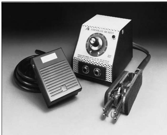
Zur Anwendung mit 1240-FPA Lötpaste; erlaubt ausgezeichnete Lötverbindungen bei DMS-Anwendungen über 260°C. Variable Leistungssteuerung für Einstellwerte von 0 bis 100 W und 0 bis 3 VAC. Der Steuertransformator ist mit Sicherung und Kontrolllampe ausgerüstet. Fusschalter und Pinzetten-Elektroden machen das Gerät leicht und sicher handhabbar. Steuertransformator und Fusschalter mit 3-Leiter NEMA- Steckern, Handgriff mit Pinzetten-Elektroden und Ersatzelektroden.
