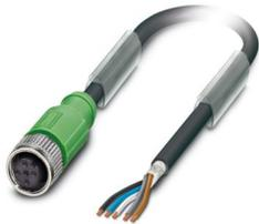
Sensor-/Aktor-Kabel, 5-polig, geschirmt, freies Leitungsende, auf Buchse gerade M12, Kodierung: A, Kabellänge: Freie Eingabe (0,2 ... 40,0 m)
