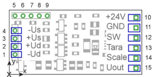
Abbildung 3: Anschlussbelegung, Ansicht: Oberseite
