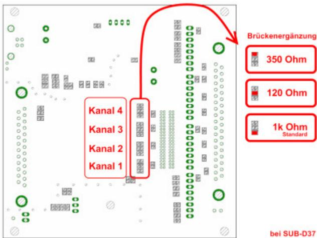
Abbildung 4: Lötbrücken für die Konfiguration der Brückenergänzung
