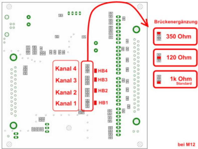
Abbildung 3: Lötbrücken für die Konfiguration der Brückenergänzung
