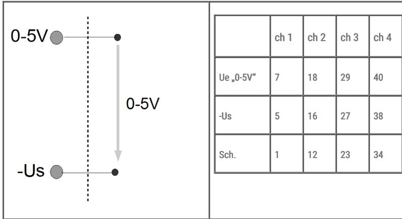
Schalterkonfiguration GSV-4BT M12
