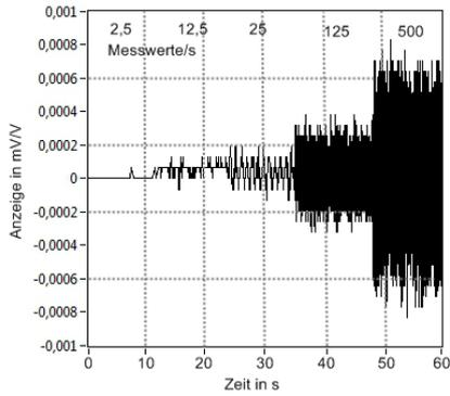
Das erreichbare Verhältnis Signal/ Rauschen hängt von den Umgebungsbedingungen (Kabellänge, Schirmung) und von der eingestellten Datenrate ab. Die Grafik zeigt die Auflösung mit 1m Anschlusskabel, Messbereich  $\pm 2\text{mV/V}$  und 350 Ohm DMS - Simulator an Kanal 1.
