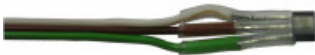
Abbildung 3: Hallschalter HAL501 im TO92 Gehäuse, Aufsicht auf sensitive Fläche (zum magnetischen Südpol zugewandt)
