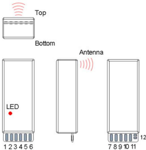
Hinweise: Die Antenne darf nicht durch leitfähige Materialien oder Flüssigkeiten abgeschirmt werden. Die Status-LED zeigt an, ob eine Bluetooth Verbindung besteht.
