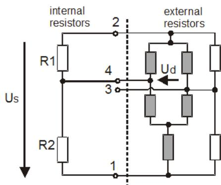
Abbildung 4: Anschlussplan für GSV-3BT QB für unsymmetrische Vollbrücken
