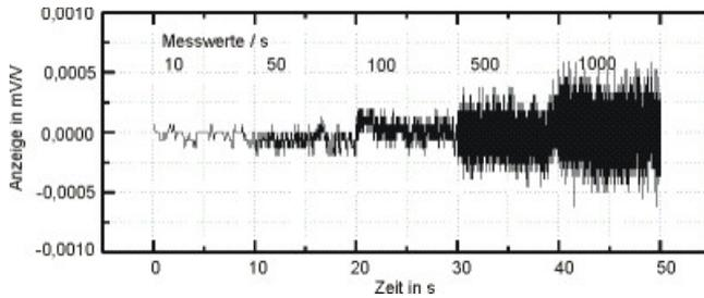
Das erreichbare Verhältnis Signal/ Rauschen hängt von den Umgebungsbedingungen (Kabellänge, Schirmung), von der eingestellten Datenrate und von der optional zugeschalteten FIR Filterung ab. Die Grafik zeigt die Auflösung mit 1m Anschlusskabel, Messbereich  $\pm 2\text{mV/V}$ , FIR Filter ausgeschaltet.
