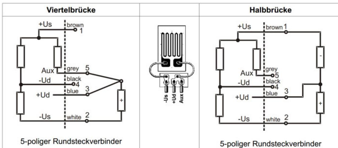
**HINWEIS:** Es können max. 2 beliebige Kanäle mit minimaler Sensorlast von 87 Ohm betrieben werden. Die anderen 2 Kanäle können mit minimal 350 Ohm belastet werden. Wenn die Stromausgänge nicht benutzt werden, können alle Kanäle mit einer minimaler Sensorlast von 120 Ohm betrieben werden. Diese Begrenzung ist aus Gründen der thermischen Stabilität notwendig.
