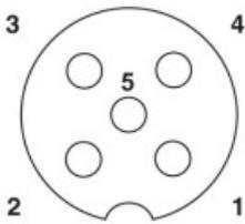
Bei M12-Buchsenvariante ist keine Sechisleitertechnik möglich.
