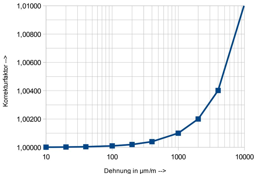
**Abbildung 1: Korrekturfaktor als Funktion der (linearisierten) Dehnung.**
