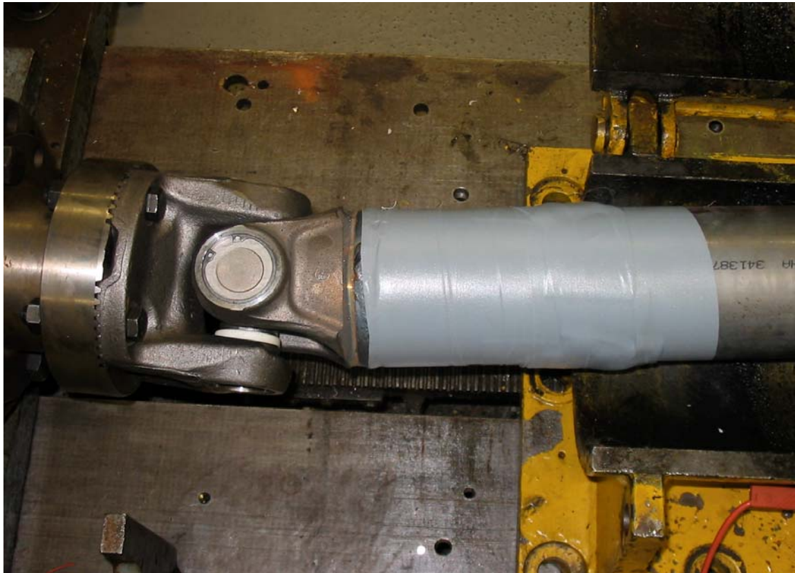
Abb. 2: Fixierung und Schutz der Messkomponenten mit Tape
