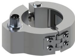
Die beiden Halbschalen des Dehnungsaufnehmers DAdx werden an Säulen montiert, um die Presskraft z.B. von Stanzen oder die Vorspannkraft von Werkzeugen zu erfassen. Dieser Dehnungsaufnehmer eignet sich ebenso wie DA40 und DA54 sowohl für die statische als auch für die dynamische Kraftüberwachung.
