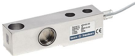
Die Wägezelle ACB wird in Plattformwaagen eingesetzt. Dabei tragen drei bis vier Wägezellen eine Plattform beliebiger Größe. Die Ausgangsstromkalibrierung erlaubt die Parallelschaltung der Wägezellen für den Betrieb an einem gemeinsamen Messverstärker ohne zusätzlichen Abgleich.
