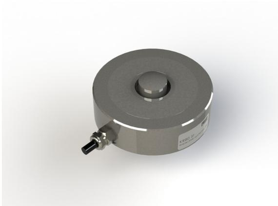
Die Wägezelle KR80 ist eine Präzisions-Wägezelle in zylindrischer Ausführung. Sie ist hermetisch dicht verschweißt und in eichfähiger Ausführung entsprechend den europäischen Anforderungen nach OIML R-60 bis Klasse C6 verfügbar. Sie zeichnet sich durch einen besonders geringen Messweg von nur 0,1mm aus.
