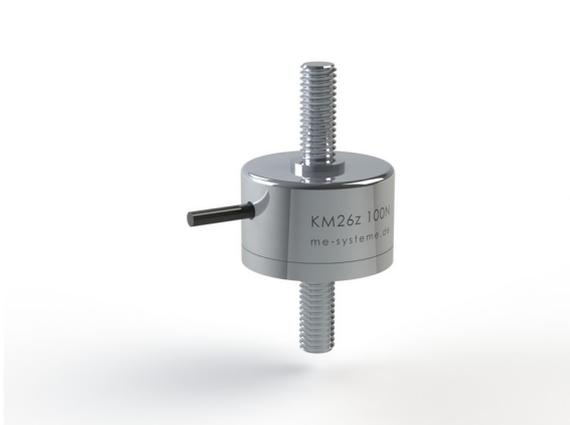
Die Kraftmessdose KM26z ist ein Membran-Kraftsensor mit kleinen Abmessungen, der zur Messung von Zug- und Druckkräften eingesetzt wird. Für die Krafteinleitung sind zwei Gewinde M6 vorgesehen. Die Schutzart ist IP 67. Die Krafteinleitung muss frei von Querkräften und Biegemomenten erfolgen.
