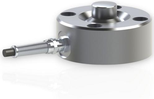
Der Kraftsensor KM90 ist ein Membran-Kraftsensor zur Messung von Druckkräften. Der Kraftsensor wird mit vier Schrauben M8 von oben auf einer ebenen Fläche mit M8 Gewindebohrungen befestigt. Alternativ wird der Sensor von Unten mit 4 Schrauben M10 befestigt. Für die Krafteinleitung ist eine Kalotte mit Radius 100 mm vorgesehen.
