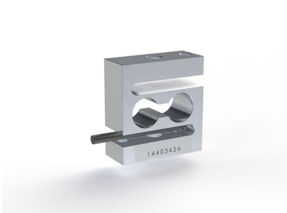
Der Kraftsensor KD24S ist ein universell einsetzbarer Kraftsensor in S-Form. Er eignet sich hervorragend für Prüfaufgaben in der Qualitätssicherung sowie in der Werkstoffprüfung. Krafteinleitung und Kraftausleitung sind zentrisch angeordnet. Die Krafteinleitungsbügel werden bei Belastung parallel verschoben.
