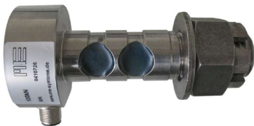
Roboste Ausführung mit Hutmutter und Splint; Durchmesser 20mm zur Wiegung von Behältern; Maximallast 10t
